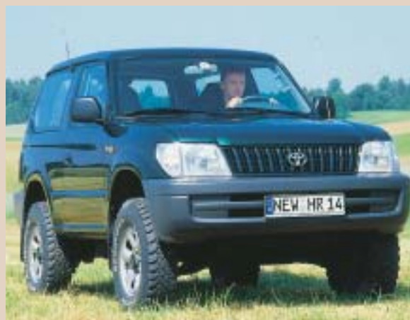
280 Millimeter Bodenfreiheit dank OME-Fahrwerk und 235/85-R-16-Reifen
