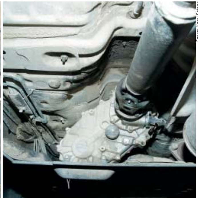
Permanenter Allrad: Im Verteilergetriebe sitzt die dritte Sperre.
