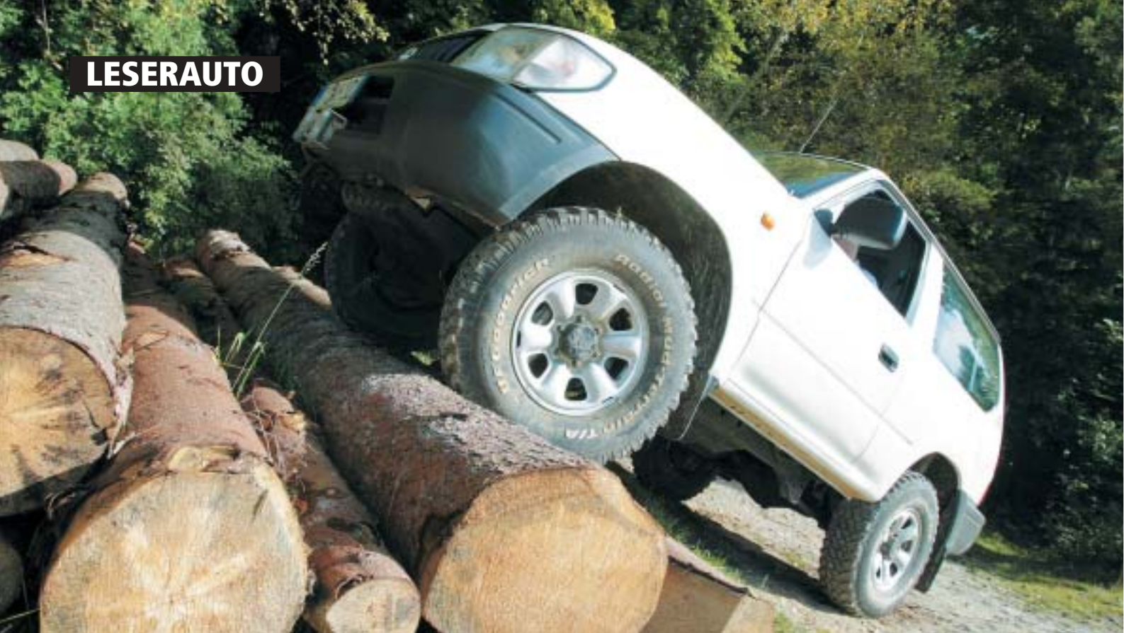
Kratzfrei: Durch die Höherlegung verbessern sich die Böschungswinkel. Falls es einmal nicht reicht, sind die Stoßfänger unlackiert.
