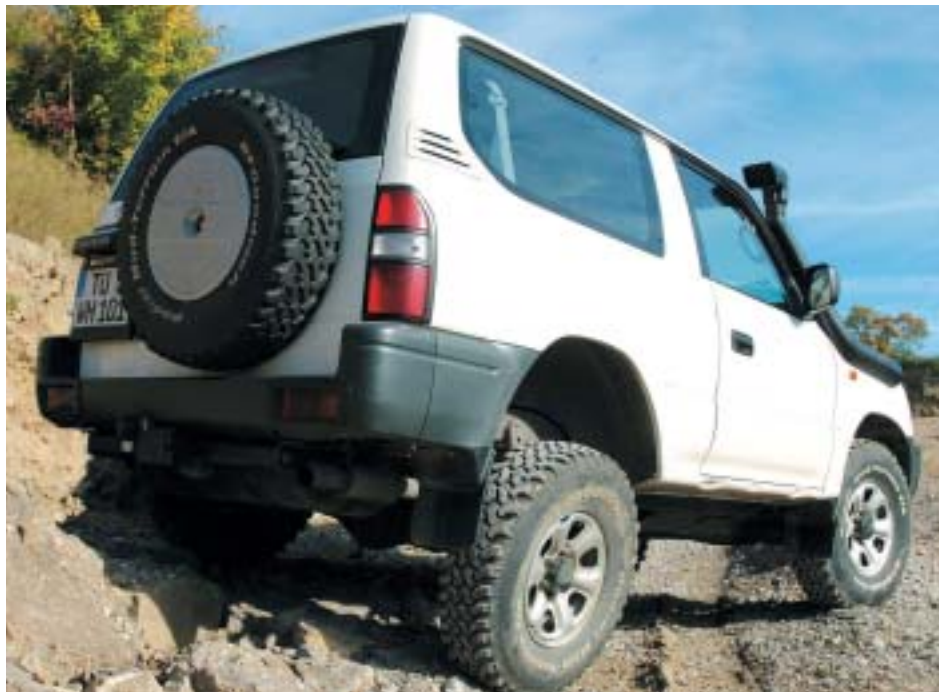
Griffig: Die Mud-Terrain-Reifen bringen zusätzlich 35 Millimeter Bodenfreiheit.
