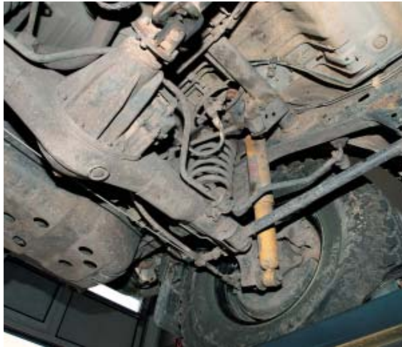
Gezügelt: Neue OME-Dämpfer an der Hinterachse.
