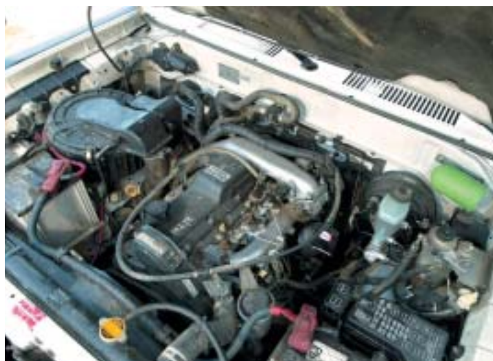
Versteckt: Der grüne Kunststoffbehälter dient als Druckreservoir.
