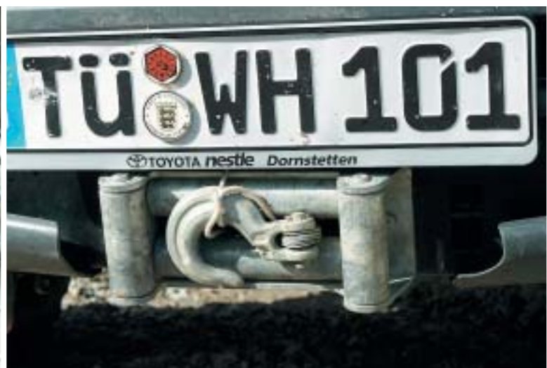
Zurückgezogen: Die Seilwinde ist verdeckt eingebaut.
