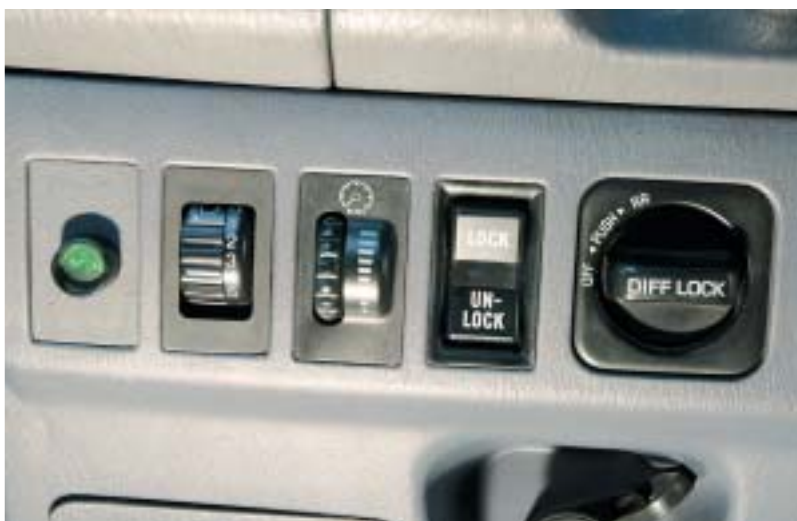
Unscheinbar: Kippschalter für die Vorderachs-Sperre.
