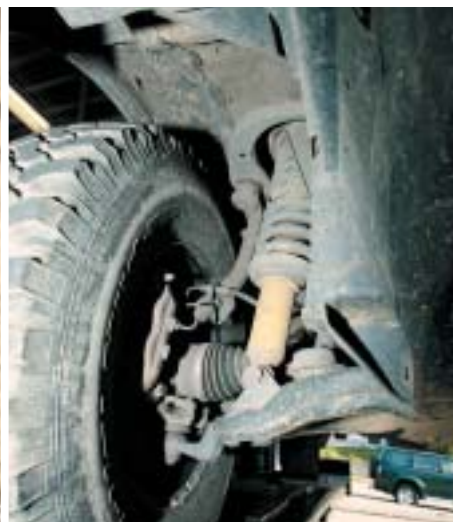
Diffizil: Federwechsel an den Federbeinen.
