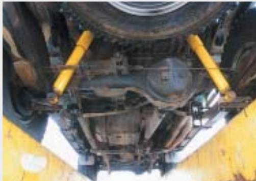
Die gelben Stoßdämpfer verraten das Nachrüstfahrwerk von Old Man Emu
