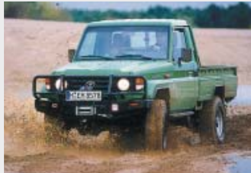
Die massive ARB-Stoßstange trägt die Seilwinde und einen stabilen Rammschutz
